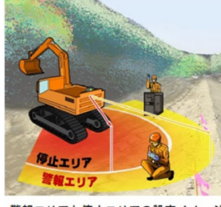
警報エリアと停止エリアの設定イメージ クアトロアイズの認識イメージ
