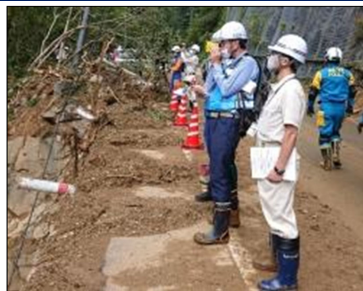
写真-1 河川を挟んで対岸から崩壊地の状況をレーザー測量器で簡易測量
