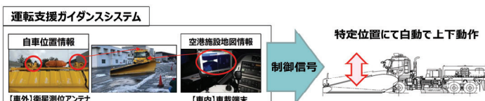
運転支援ガイダンスシステムの概要 出所：第7回空港除雪の省力化・自動化に向けた実証実験検討委員会 資料
