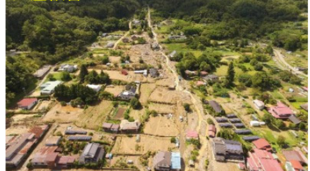
長野県下馬沢川での土石流・土砂流氾濫被害
