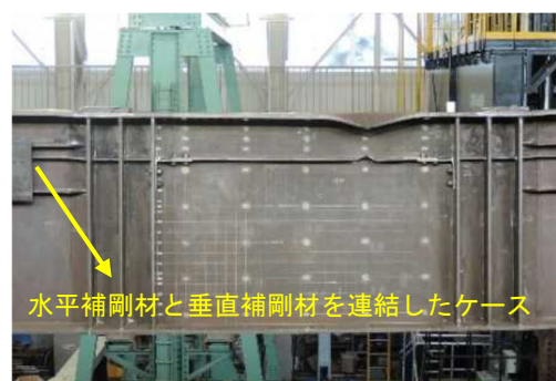
図4-5-1 補強した既設鋼桁を模擬した載荷実験
