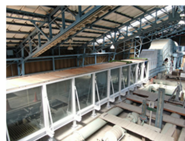
台風防災実験水路
