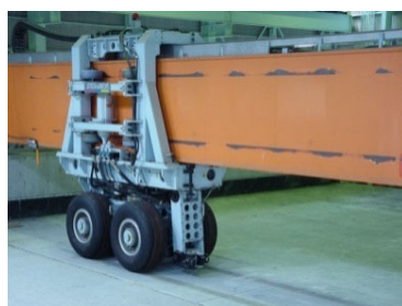
航空機荷重載荷装置
