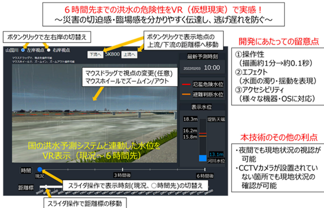
図 3-10-4 VR技術を用いた河川水位予測情報の3次元標示の例
