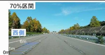
※ 上記の剥離率は、剥離率が60%及び70%の区間にある区画線を対象として、影の影響が少ない時間(10時~12時)かつ日射の影響が少ない昇順方向で計測
