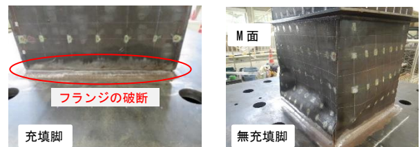
写真-2 試験後試験体状況 (M面)
