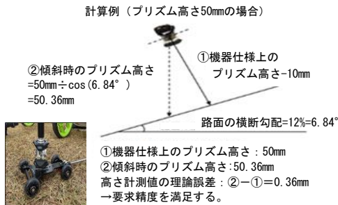
図-1 地上移動体搭載型プリズム及び理論誤差の計算例
