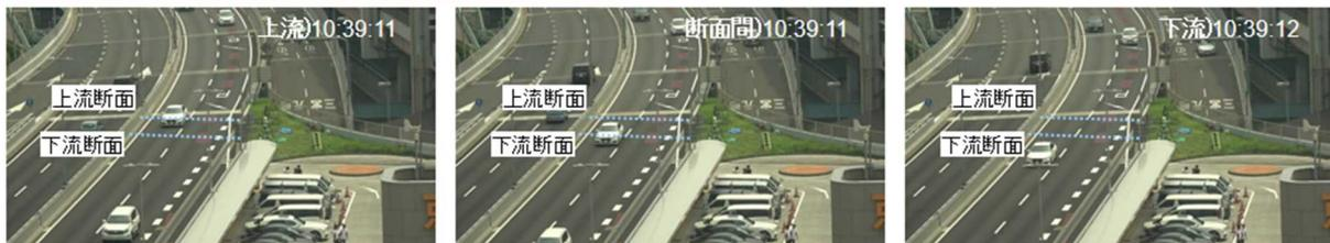
検知漏れとなった例(第一車線を走行しているが検知せず)
