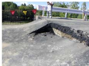
段差実験例 (舗装)
