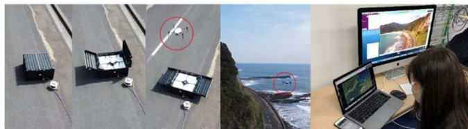
図-2 自動航行 UAV の離陸及び遠隔操作状況
