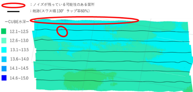
図-3.20 地形段彩図 (荻田港：スワ幅130° ラップ率60%)
