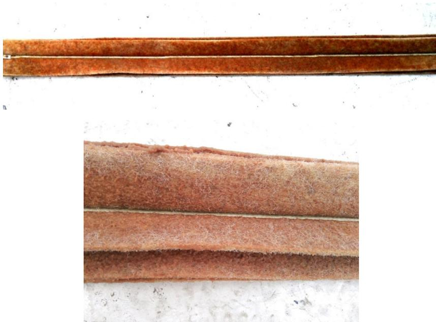
図資 4-13 立上げ試験終了時のアナモックス槽充填担体
