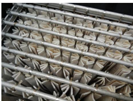
図資 4-11 立上げ試験に使用した担体（アナモックス種汚泥投入前）
