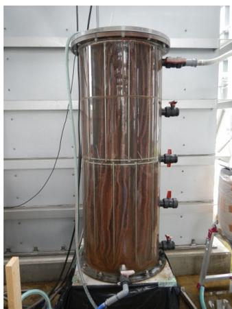
図資 4-8 ベンチスケールアナモックス装置の外観
