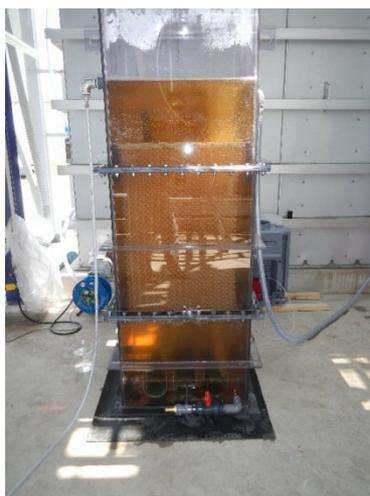
図資 4-6 ベンチスケール亜硝酸化装置の外観
