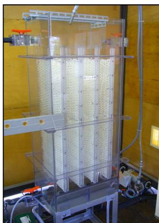
図資 4-14 高負荷有機物除去装置の外観
