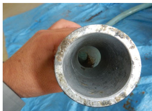
図資 1-46 薬液洗浄実施後の取水設備状況（左：脱水ろ液取水ポンプ，右：吐出配管）
