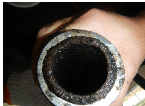
図資 1-45 取水設備 MAP 析出状況（左：脱水ろ液取水ポンプ，右：吐出配管）
