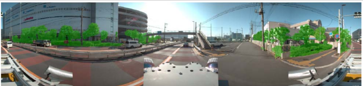
MMS (Mobile Mapping System) 車両搭載型測量システムの車載360度カメラ画像を用いた分析の例
