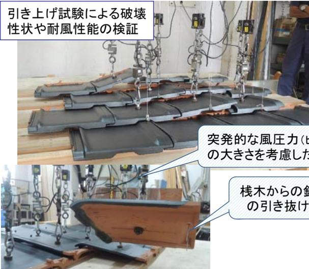
突発的な風圧力(ピーク風力)の大きさを考慮した載荷
