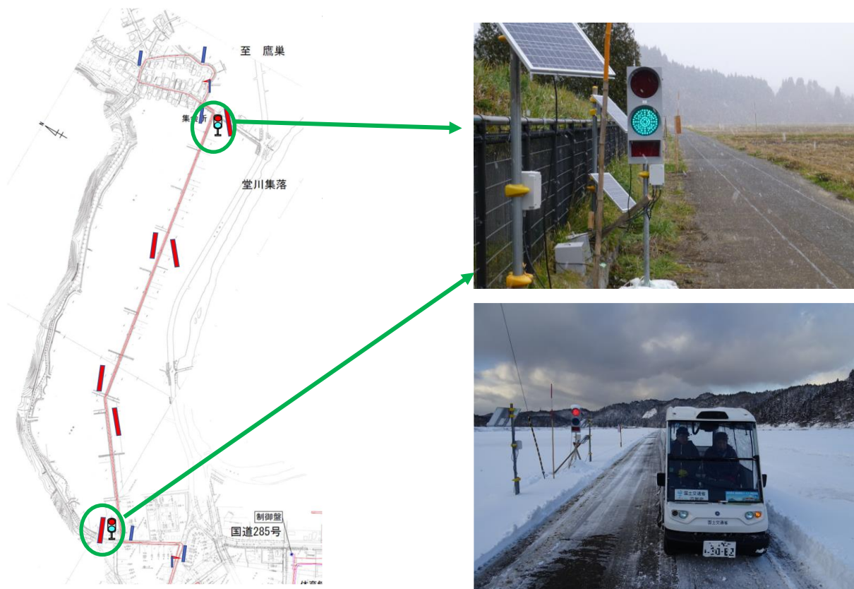
図3-25 仮設信号の設置
