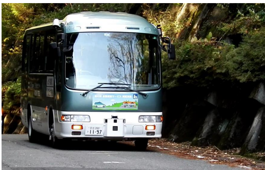
図3-19 山間部において自動運転を継続している状況（磁気マーカ方式）
