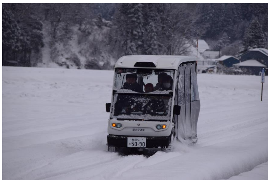
図3-16 積雪路面において自動運転を継続している状況（電磁誘導線方式）
