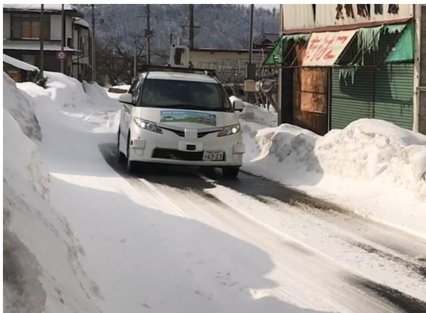
図3-12 除雪された雪を障害物として検知してしまうため手動介入が発生 (道の駅 たいら)
