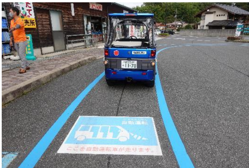
図3-42 道の駅に設置した自動運転車の走行ルートを示す路面標示（近景）
