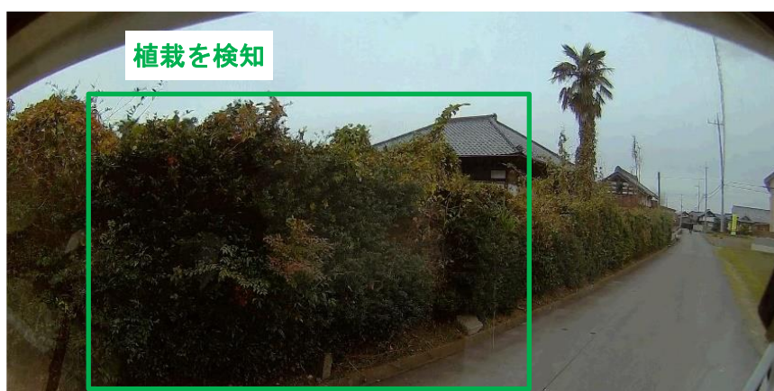
図3-11 植栽を障害物として検知（道の駅 ひたちおおた）
