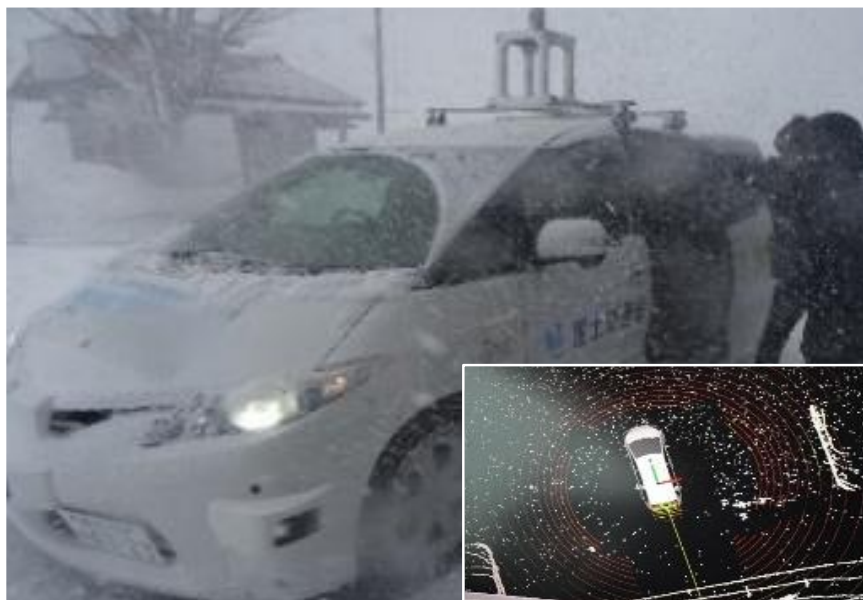
図3-15 降雪時のLiDARの検知状況（道の駅たかはた）
