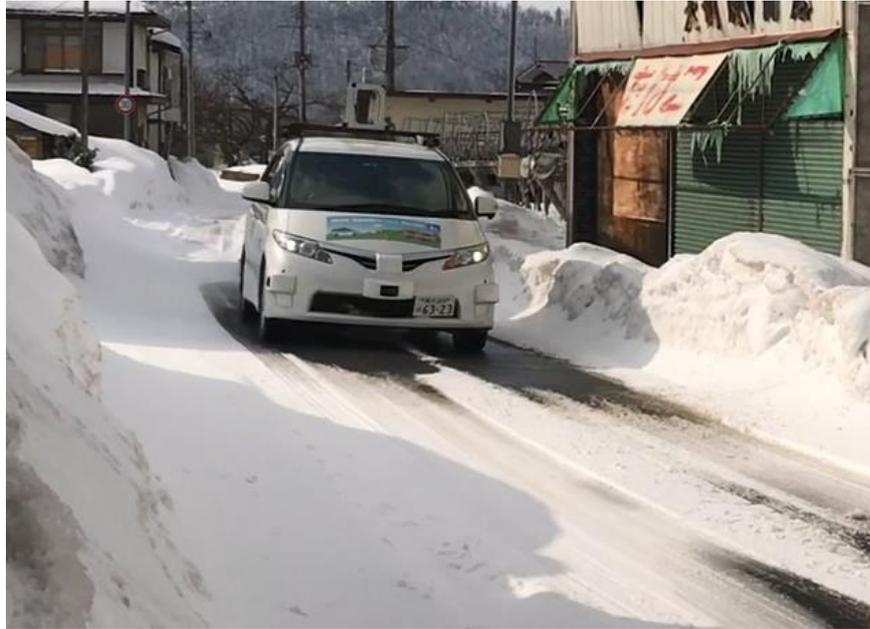
図3-12 除雪された雪を障害物として検知してしまうため手動介入が発生
