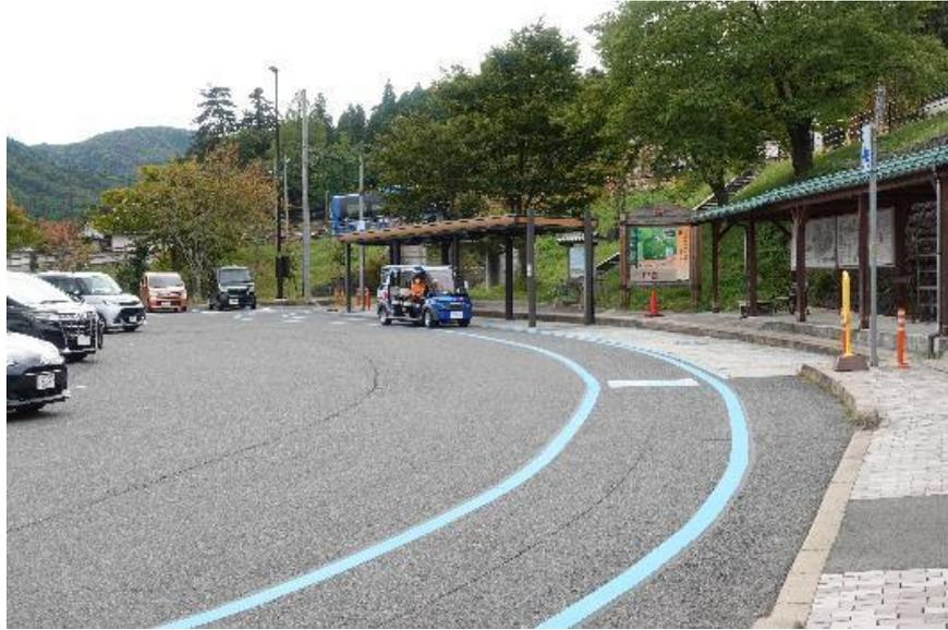
図3-41 道の駅に設置した自動運転車の走行ルートを示す路面標示（全景）
