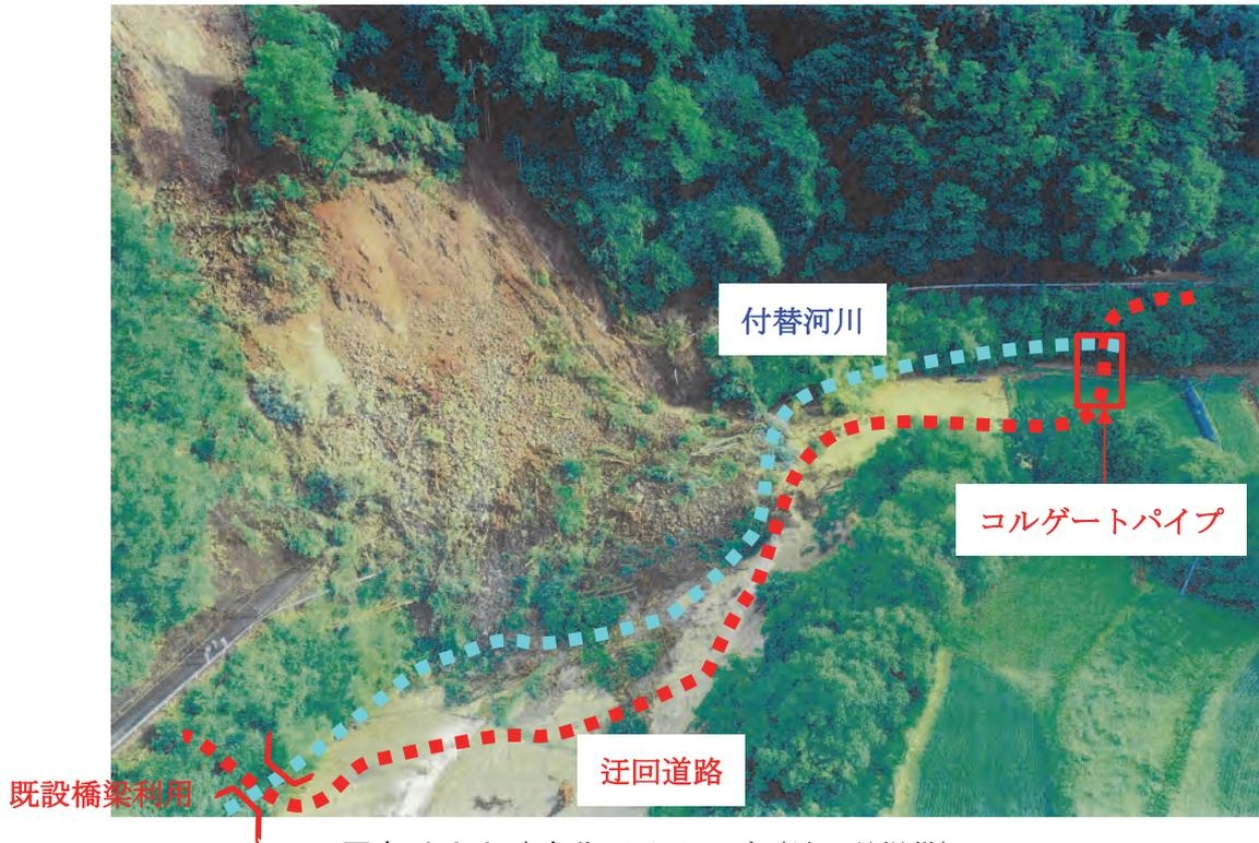
写真-4.2.2 応急復旧イメージ（長野県提供）
