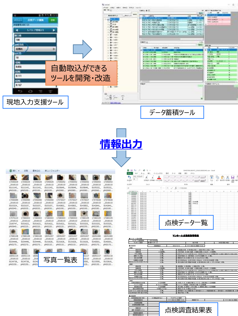
図 2-13 データ蓄積ツールの概要
