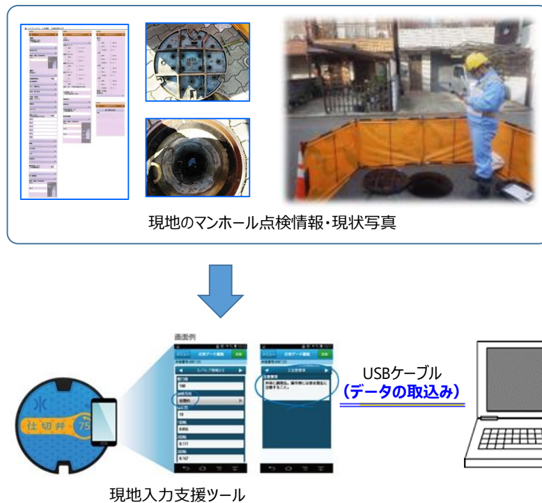
図 2-52 現地入力支援ツールの概要図
