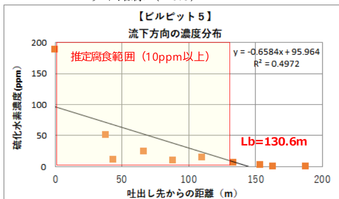
図 2-48 流下方向の濃度分布 (ビルピット No. 5)
