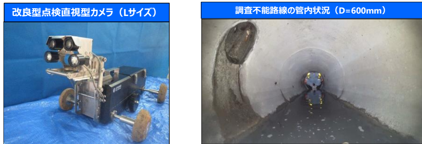
図 2-24 改良型点検直視型カメラと調査不能路線の管内状況写真
