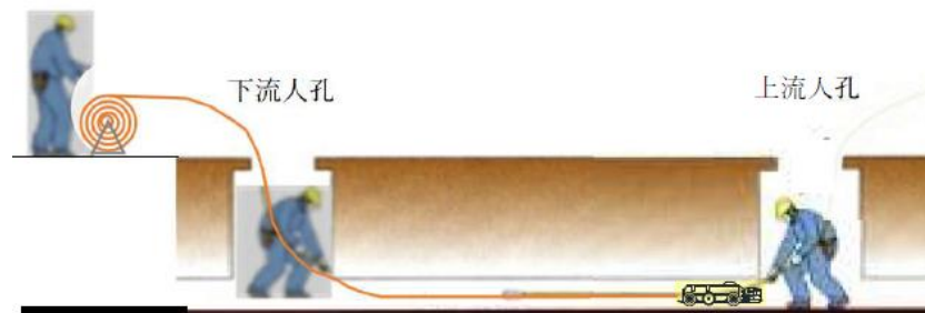
図 2-23 通線によるカメラ調査の様子
