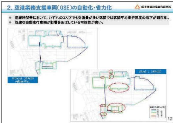
その結果がこちらに示した図で、こちらは車両の平均速度を図示しています。青い色の部分がやや遅めの速度で、赤に近づくほど遅くなるということです。左側が自動走行なしの場合で、右側が自動走行を一部 100%にしたところ。そうしますと、違いが出てくるように、右の図の方では黄色い線とかオレンジの線が出てきます。平均速度が低下しているということを意味しています。
