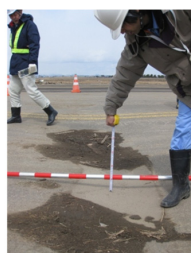
仙台空港の誘導路(アスファルト舗装)の液状化による局所沈下
