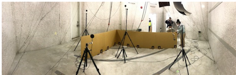
パーティションの残響室吸音率測定状況
