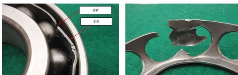
図資 1-26 No.4 汚泥ポンプベアリング検証結果
