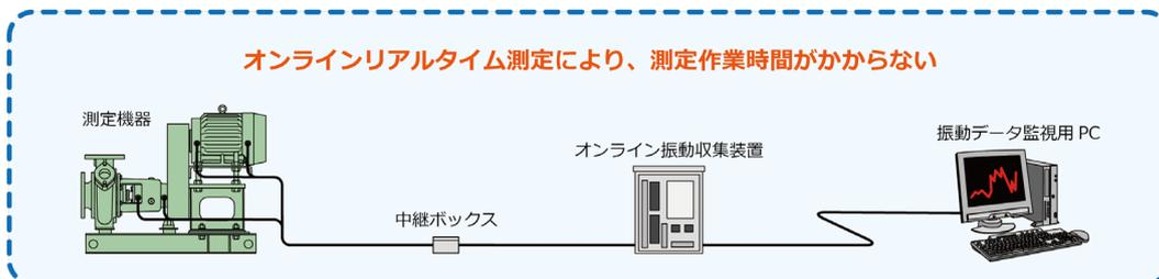
図資 1-72 振動測定作業の代替効果イメージ
