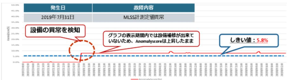
図資 1-47 水処理設備の異常発生時の分析結果
