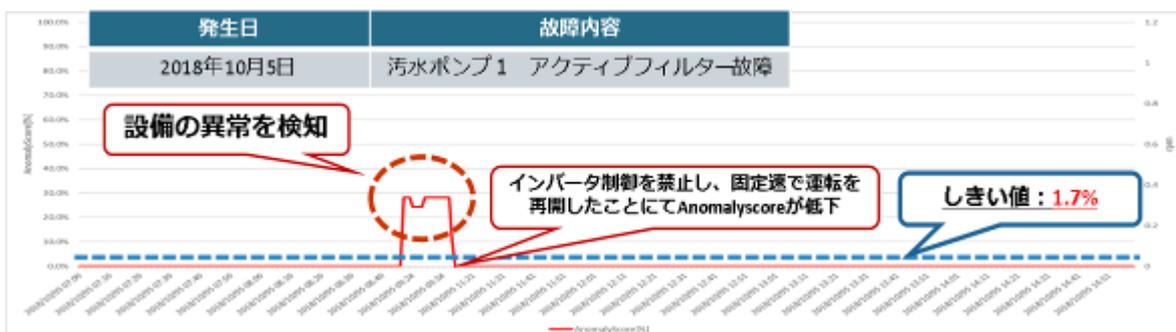
図資 1-46 汚水ポンプ設備の異常発生時の分析結果
