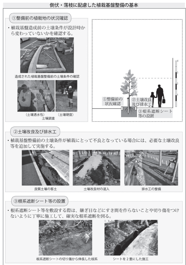
図6 植栽基盤整備工における配慮事項
