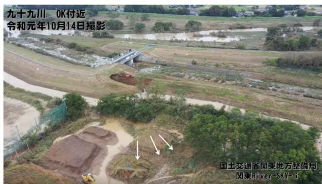
写真-5.2.3.8 決壊箇所の堤内地側植生倒伏 (出典：関東地方整備局 9) )
