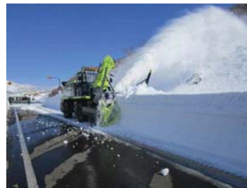
i-Snowロータリー除雪車 (平成31年3月 知床横断道路) 出典：国土交通省 北海道開発局
