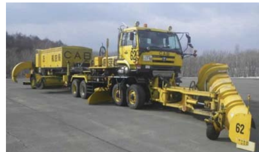
除雪車両の外観（高性能プラウ） 出典：東京航空局 新千歳空港事務所
