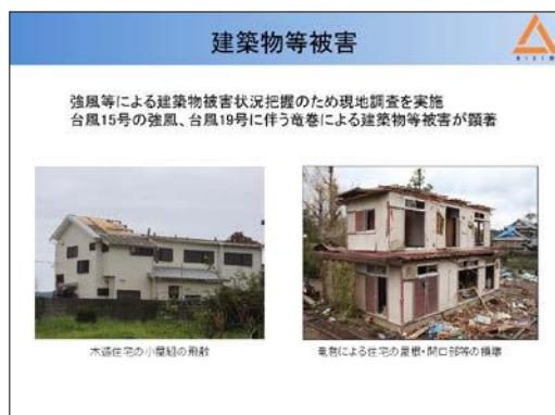
建築物につきましては、台風15号の強風、台風第19号に伴う竜巻による被害が甚大でありました。左は、台風第15号の強風による木造住宅の小屋組の被災、右は、台風第19号に伴う竜巻による住宅の被災状況です。調査の結果、住宅の被害においては、比較的築年数が経ったと見られるもの、構成部材に著しい腐朽等が見られるものなどが比較的大きな被害を受けたことが確認されました。
