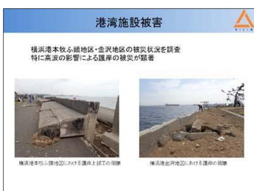
港湾施設につきましては、横浜港の本牧埠頭及び金沢地区の被災状況の調査を実施しました。本牧埠頭では、護岸上部が断続的に内側へ倒壊しており、高波による被害と考えられます。金沢地区でも同様に護岸の被災が顕著であり、一部で護岸の陥没も確認されました。以上、今回の台風被害に関する調査の結果について、速報させていただきました。
