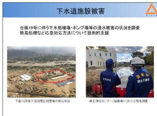
それでは、これより所管施設の被害と、それに対する調査活動の一端を報告いたします。まず、下水道施設ですが、下水処理場、ポンプ場における浸水被害等が発生しました。この画像は千曲川流域下水処理場の被災状況であります。これらの被害に対して、専門家として簡易処理などの応急対応方法に関して技術的支援を行いました。
