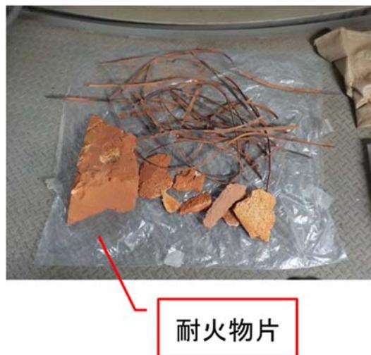
図資 1.3.6-3 流速調整用格子板回収物
