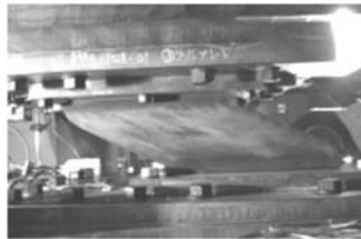
図-2 支承のせん断試験状況
