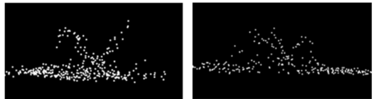
写真-4 試験体周辺の点群データ（開空度 30.6%） （左：対地高度 80m、右：対地高度 140m）
