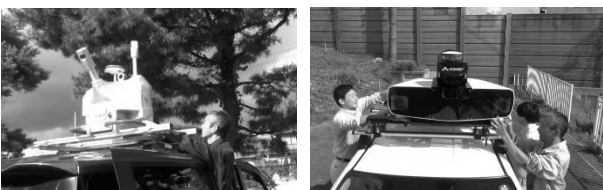
図-1 車両搭載センシング機器の取り付け作業 (左：東北、右：関東)
