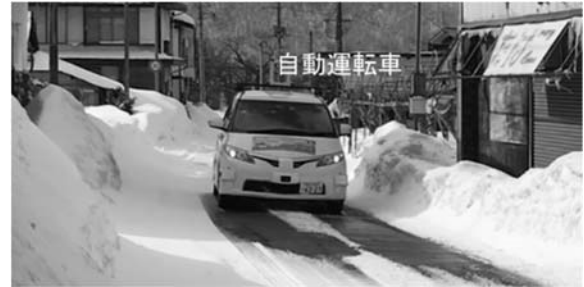
図-6 積雪による狭小幅員（本来は2車線）
