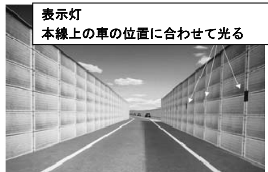
図-4 表示灯による合流支援施策の仮想実験映像
