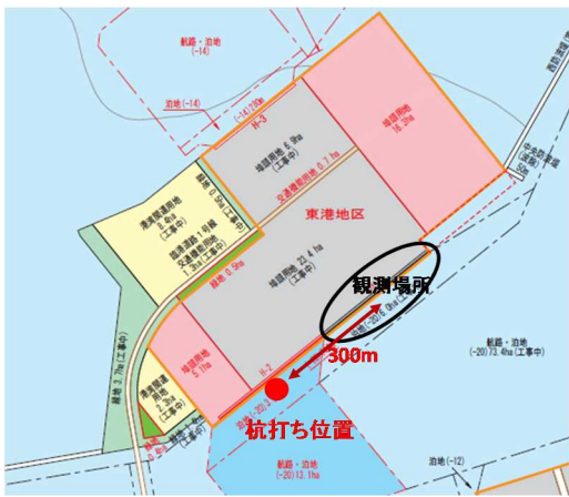
図-3.20 バイプロハンマーでの栈橋杭の打設位置の平面図
