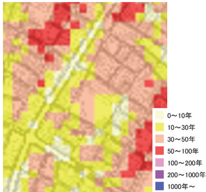
図 2.1.12 確率年の分布図（最大浸水深 40cm）
