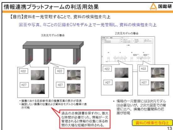
的に管理することが可能となっております。また現場で使えるようにこのアプリケーション一式をタブレット型のパソコンに格納しておりますし、更に一般的な表計算ソフトで構築しました管理ツールを用いて3次元モデルに紐付く、過去の点検結果などの外部参照ファイルを管理するといったシステムでございます。こういったシステムを使うことによりまして、例えば過去の点検結果
