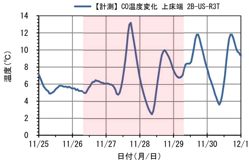
図-3.3.31 ひずみ計測位置（2B-US-C3a）近傍の温度計測結果
