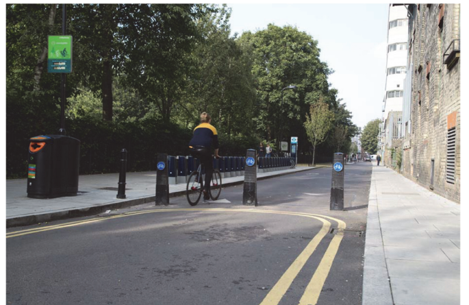
自動車の流入を排除するためのボードの設置 (イギリス ロンドン市 サイクル・スーパーハイウェイ) 出典:Central London Grid
