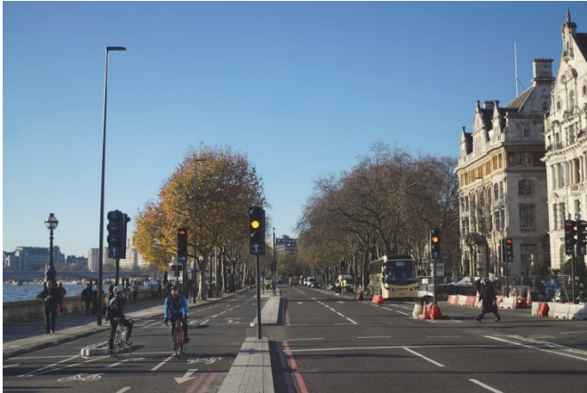
自転車専用の右折レーンを設置 (イギリス ロンドン市 サイクル・スーパーハイウェイ)
