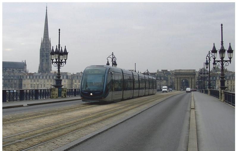
バッテリー式車両を導入した架線レス型のトラム(フランス ボルドー市)
