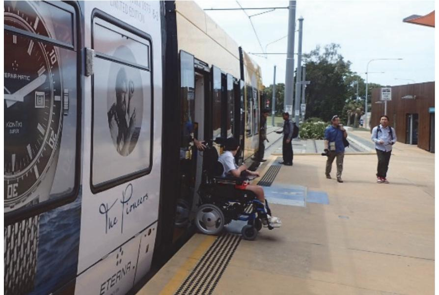
停留場とLRTの高さが同じであるため、車いすの乗降が容易(オーストラリア ゴールドコースト市)
