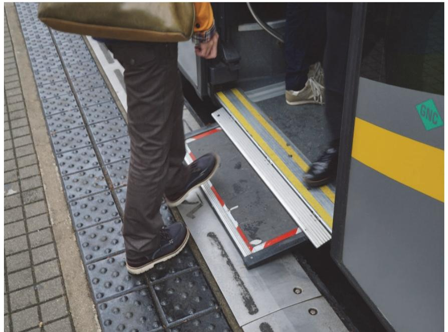
車両からスロープが出てくるBRT車両(フランス ナント市)
