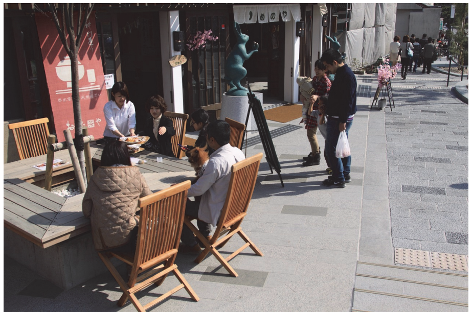
沿道店舗とワークショップを重ねて実現した、通りと沿道店舗の一体的な整備 沿道敷地内を歩道と同一平面かつ同様の石畳で整備し、 官民境界を目立たせないようにした上で、テーブルやベンチを設置している (出雲大社「神門通り」、出雲市)
