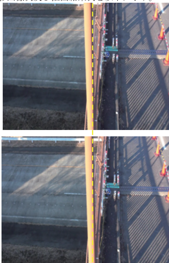
図-4. 3. 11 風によるカメラの角度のずれ
