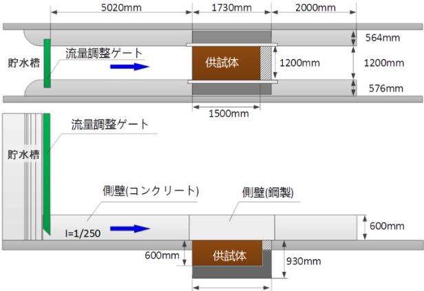
図-4 高流速実験水路の諸元
