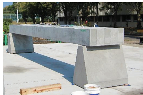
写真-3.2.2 模擬損傷供試体（D-3）
