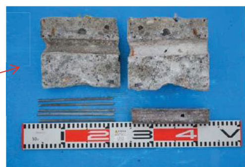
写真-3.1.6 切断後の桁断面 (C-6)
