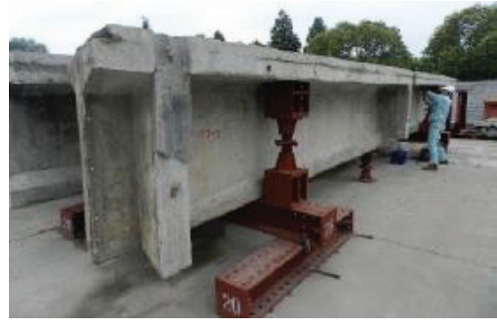
写真-3.1.3 供試体設置状況 (C 橋)
