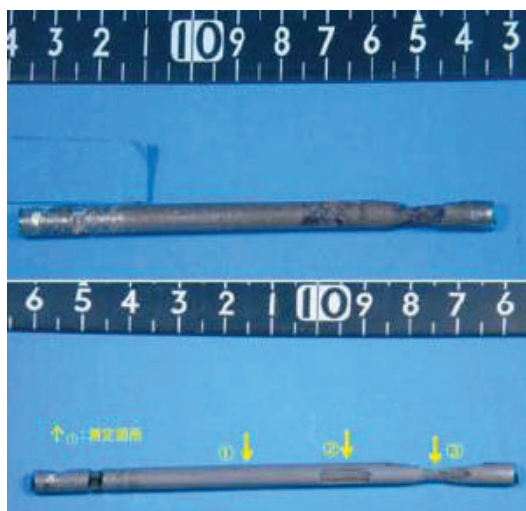
写真-3.1.9 C-6 供試体 PC 鋼線 (ケーブル NO. 4 試料 NO. 1)
