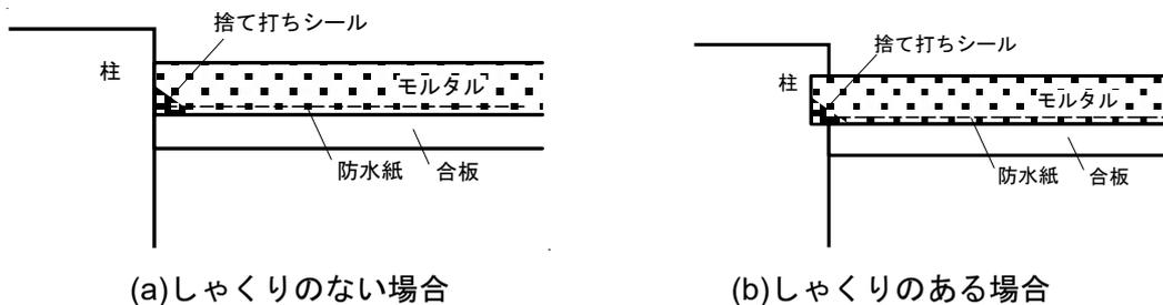
図 3.2-8 防水紙端部にシーリングを施す場合の例
