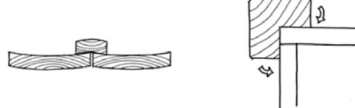
図3.2.2 木の反りを見越した材の使い方<sup>2)</sup>
