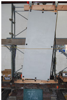
写真 1 試験体 No.1（基準）（1/10rad）
