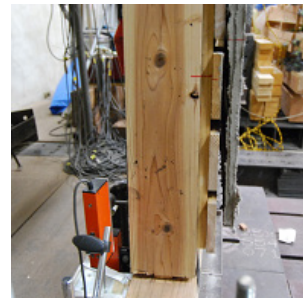
写真 1 試験体 No.1（基準）（1/10rad）
