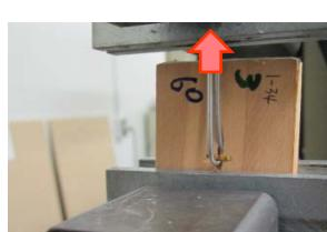
写真 2.5.4 基板面に平行の引張
