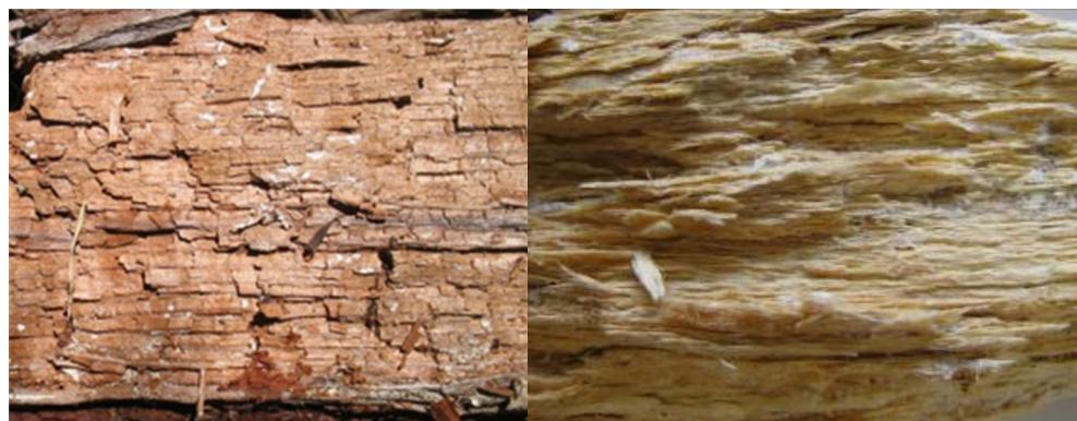
図 1.1.2 褐色腐朽材
