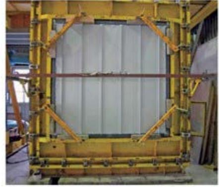
b. 圧力箱を用いた耐風圧性試験
