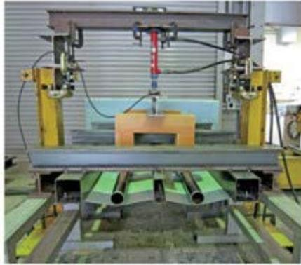
a. 鋼管を用いた線荷重載荷試験
