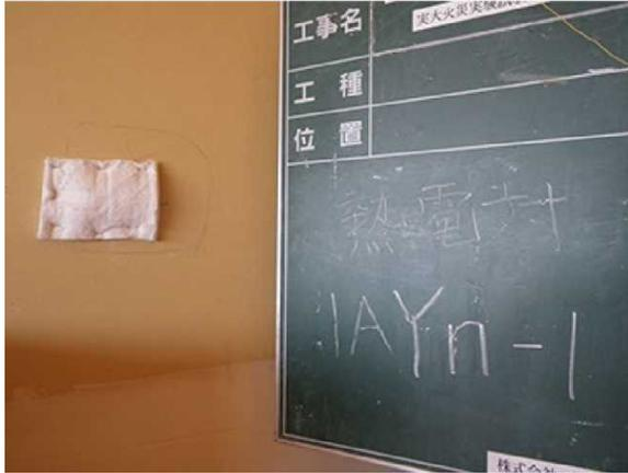
写真 3.5.3-3 壁表面熱電対の状況
