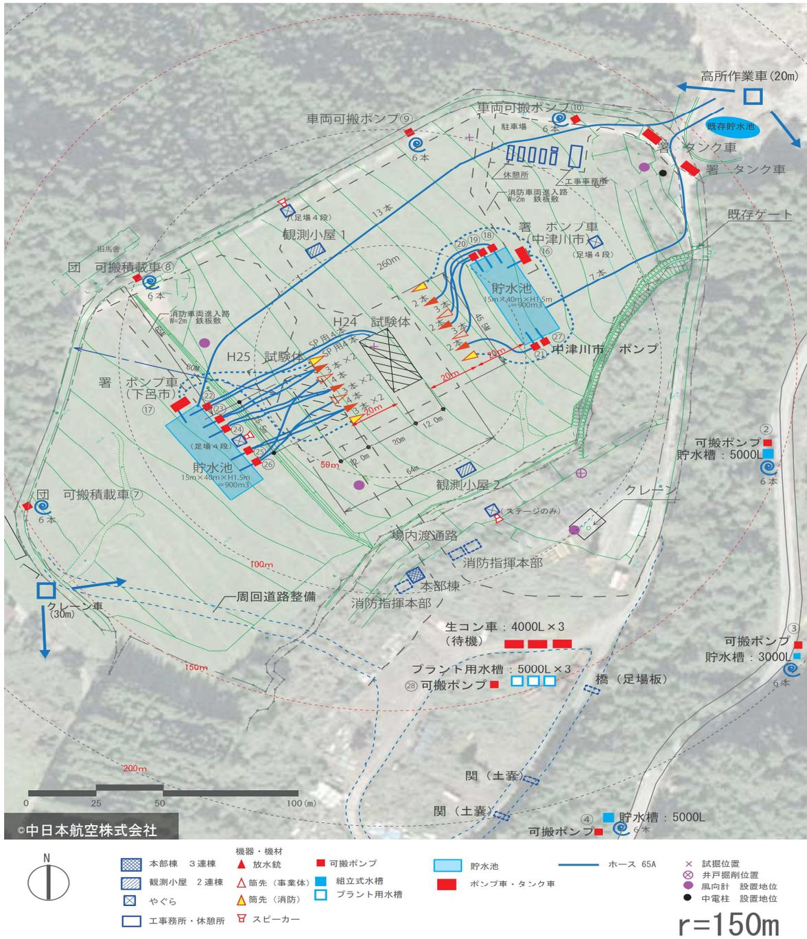
図 3.6.2-1 実験建物消火体制配置図 150m 範囲
