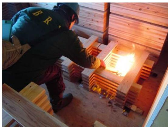
写真 3.4.3-2 クリブへの点火方法
