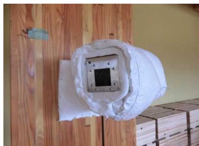
写真 3.5.2-1 建物内撮影用 CCD カメラ (耐熱加工したもの)
