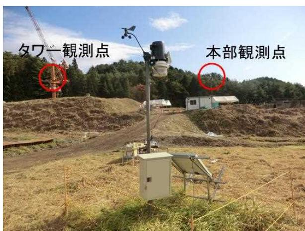
写真 3.5.1-1 気象観測装置 (実験建物観測点)
