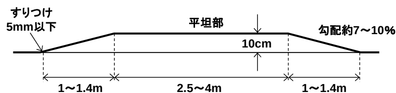
図 参-1. フランスにおける凸部（台形）の基準
