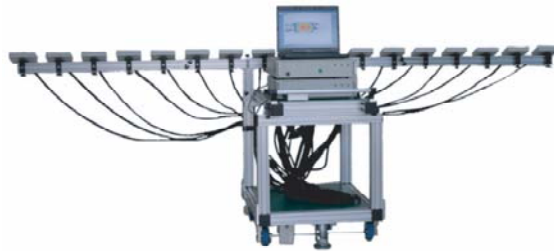
図 4.4-5 電界強度計測装置(MICRONIX 社製の ME9200 システム)
