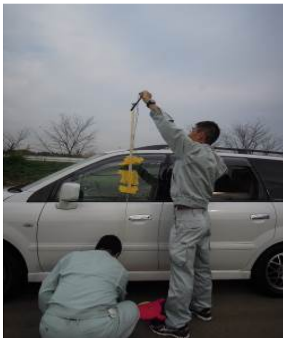
図 4.5-7 実験車両への車載アンテナ〔地上高さ 2m〕設置状況
