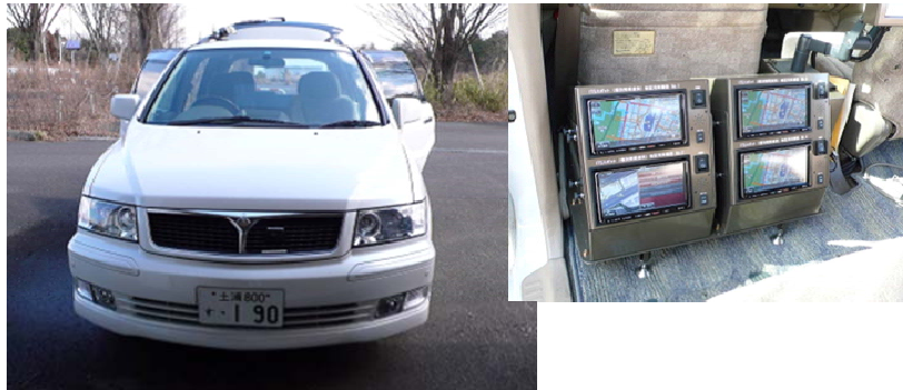
図 4.3-2 個別通信対応車載器の搭載車両と車載器搭載状況 （国総研所有：三菱シャリオグランディス）
