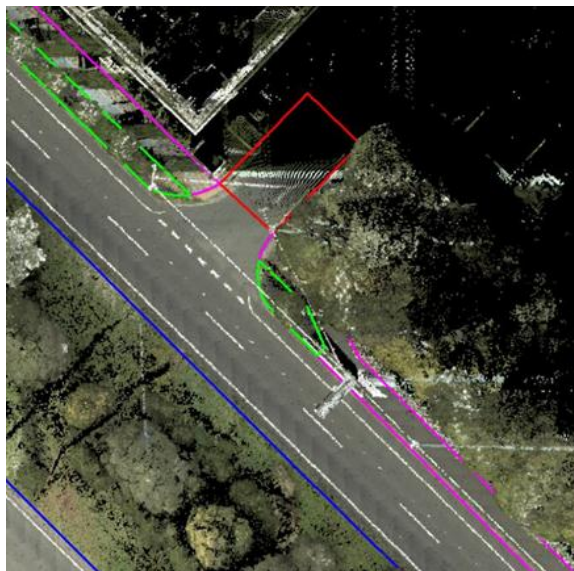
図 11 点群座標データ (RGB 付) と電子地図との重ね合わせの例
