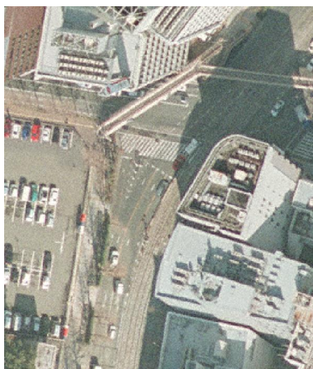
図 22 建物の倒れこみにより地物の判読ができない例
