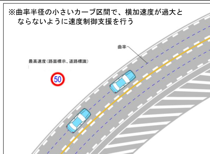
図-12 曲率半径の小さいカーブ区間での速度制御支援イメージ
